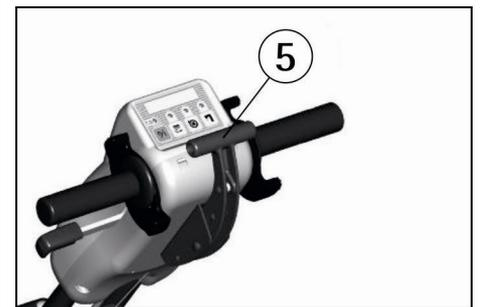
Se puede levantar la boquilla de secado cuando esta se encuentra en proximidad del punto central.
