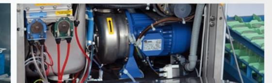
La electrobomba, con cuerpo bomba y rotor en acero inoxidable garantiza una altísima fiabilidad y eficacia. La facilidad de acceso a todos los componentes simplifican las operaciones de manutención.
